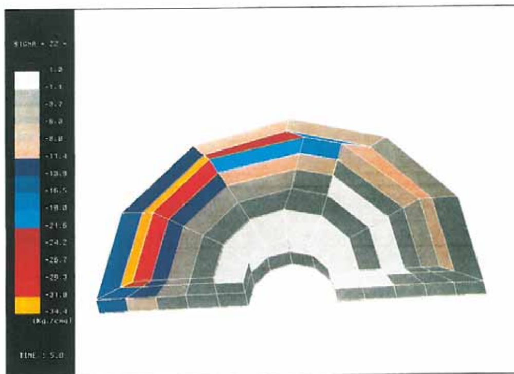
Fig. 8 Modello 3D: sforzi normali verticali sulla fondazione.
