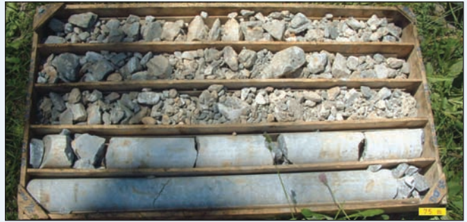
Il contatto roccia-detrito individuato nel carotaggio I
