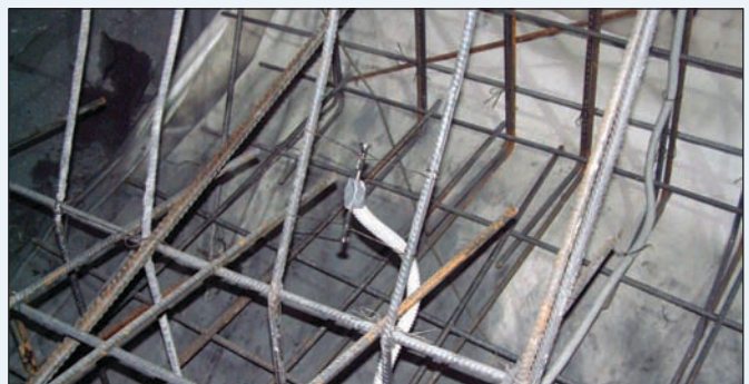
Lo strain gauge da annegare nel calcestruzzo
