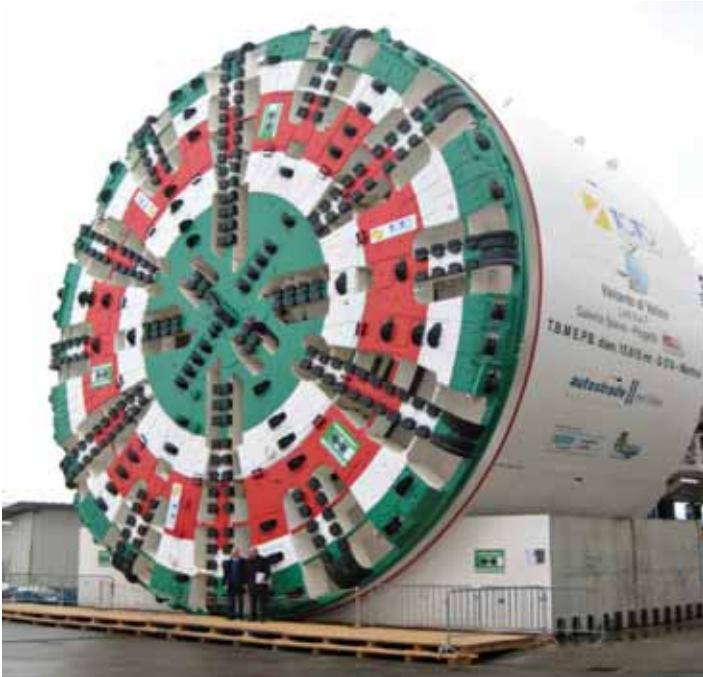
Foto 1 – La TBM-EPB “Martina” e gli apprestamenti dell’imbocco lato Firenze.
